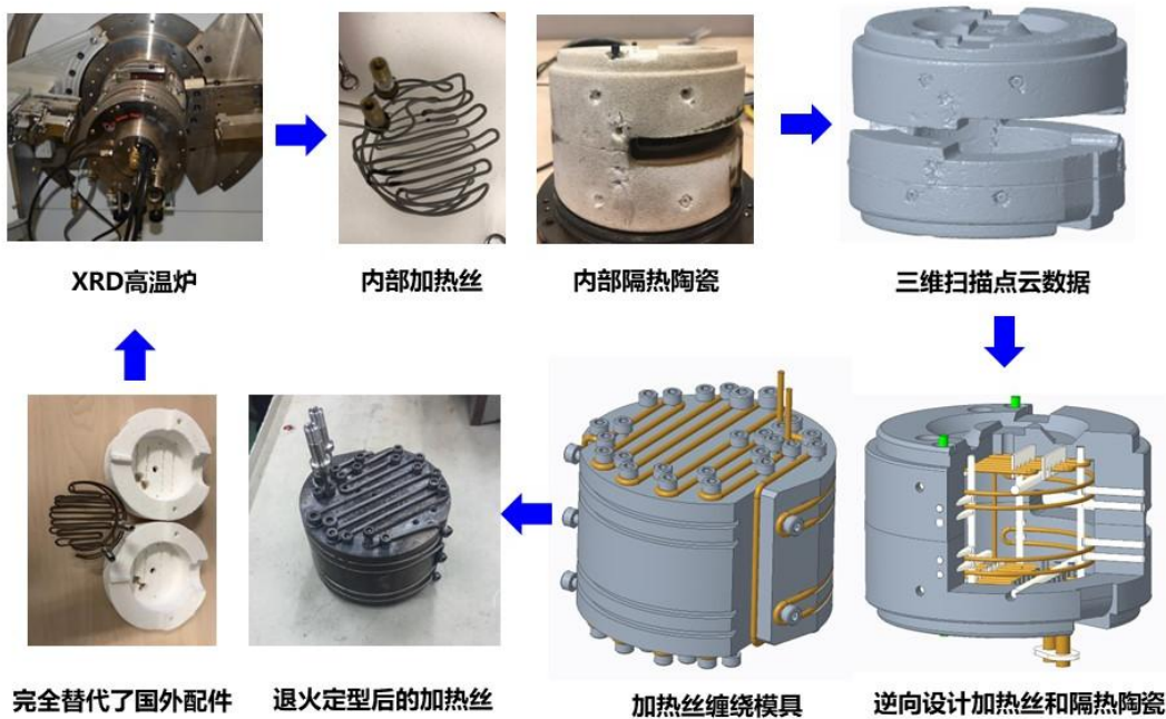
图 1、使用三维扫描仪逆向设计 XRD 高温炉耗材的工作流程示意图
