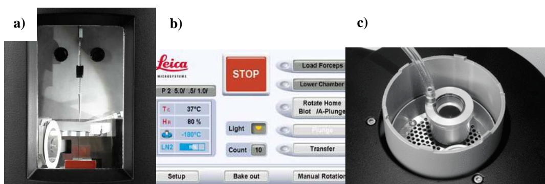
● 图 3.a)在可控的样品环境仓内向载网上滴加样品 b) 可编程的参数设定 c)液化乙烷的头部液化装置
