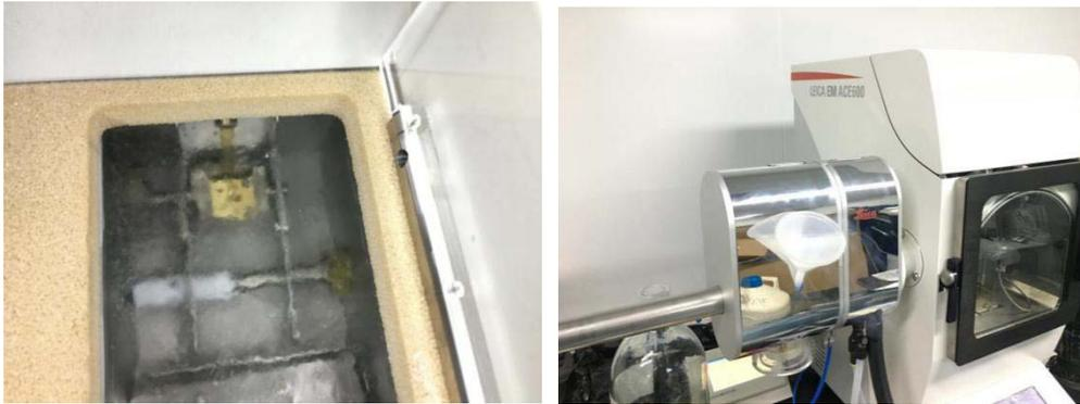
● 图 4. 冷冻样品传输至溅射仪
