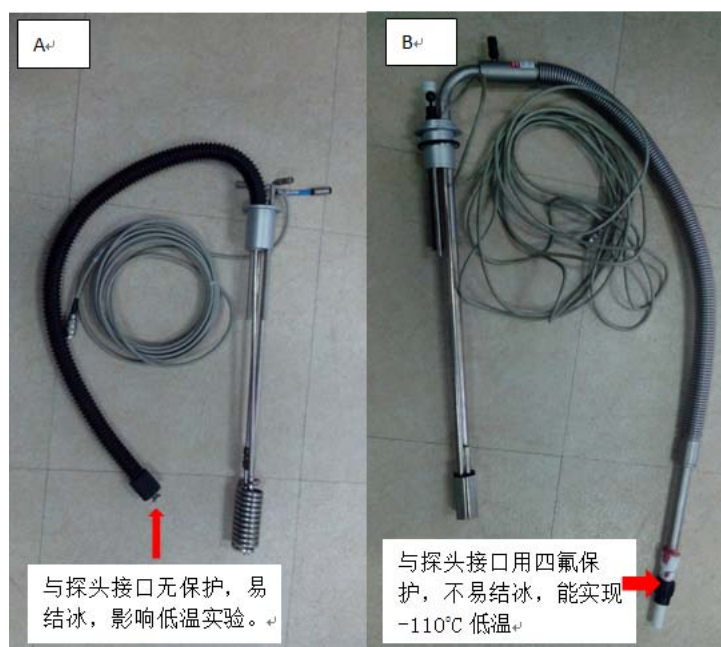
图 1 热交换式（左）和自蒸发式（右）低温装置照片
