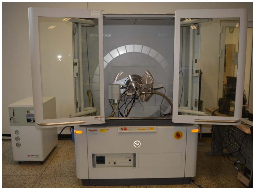
图 1 配备有变温台的多晶 X 射线衍射仪
