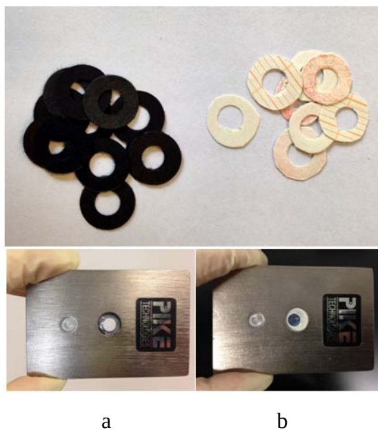
图 4 原有纸片和同心圆纸片以及红外制样对比图
