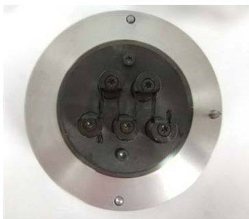
● 图 6、真空热蒸发的碳丝安装图
