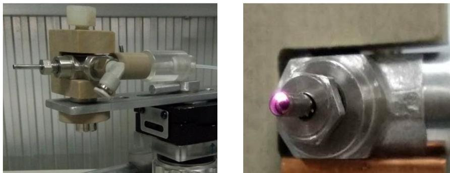
● 图 2、新型辉光放电离子源照片
