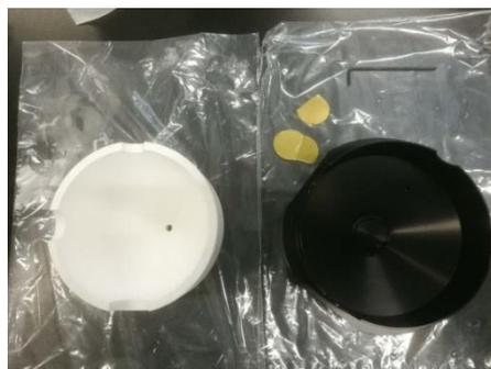
图11、积分球聚四氟乙烯内胆的拆卸
