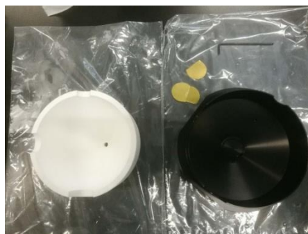
图11、积分球聚四氟乙烯内胆的拆卸
