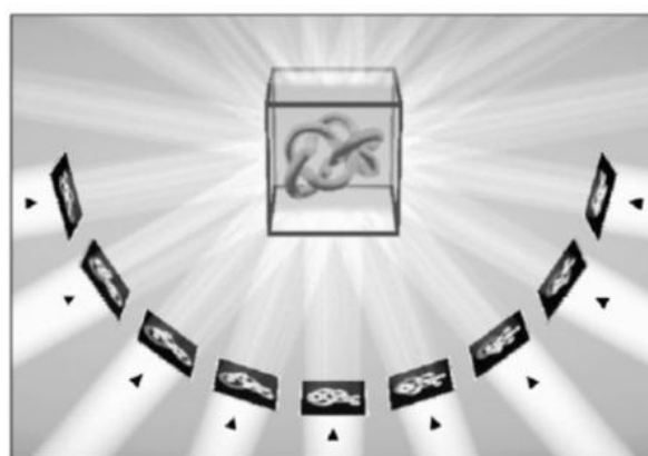
● 图 5、背投影实现二维倾斜序列计算得到断层图——图片来源于 Baumeist
