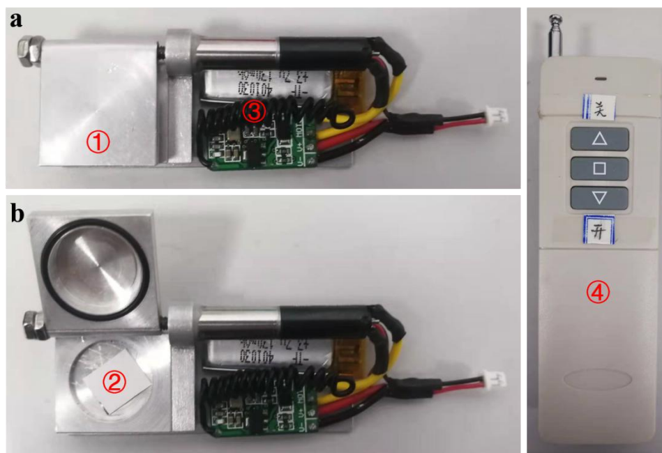
● 图 1、密封转移样品台实物图。a：关闭状态；b：打开状态。①—样品仓；②—样品；③—遥控器接收器；④—遥控器
