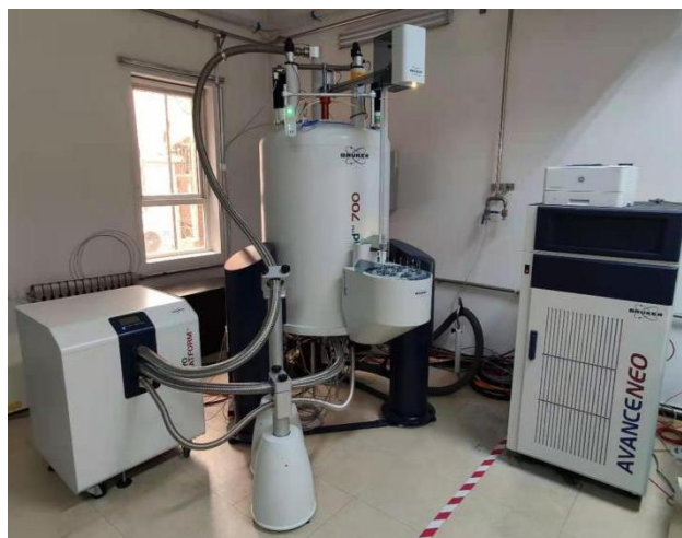
●图 1、化学所 2021 年度完成安装的布鲁克 AVANCE NEO 700 液体核磁谱仪, 配置有宽带超低温正向探头。可实现对于氢、碳、氮、磷、氟、硅、硼、锂、氘等超过 50 种原子核的高灵敏高分辨核磁表征(国内同类高场仪器最多氢/碳/氮/磷 4 种原子核)。
