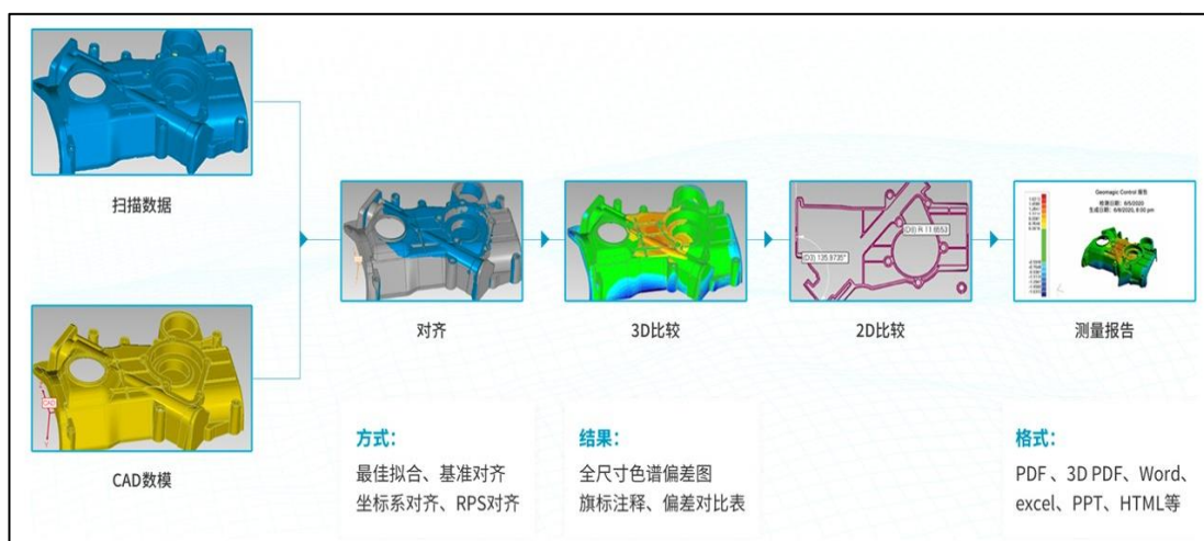
图 2、使用三维扫描仪评估复杂零件加工精度的工作流程示意图
