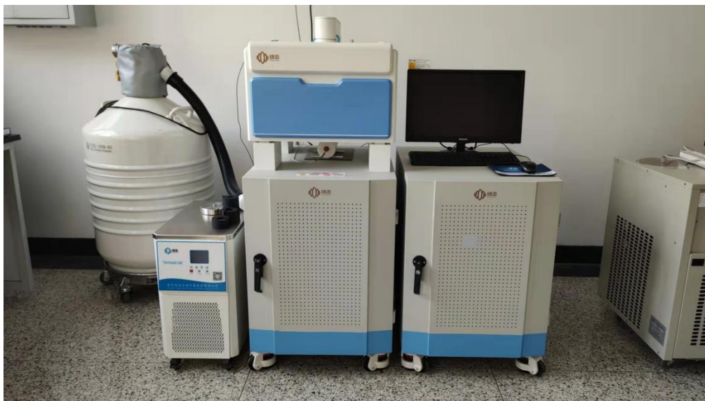
●图 4、化学所近期安装的低场核磁谱仪
