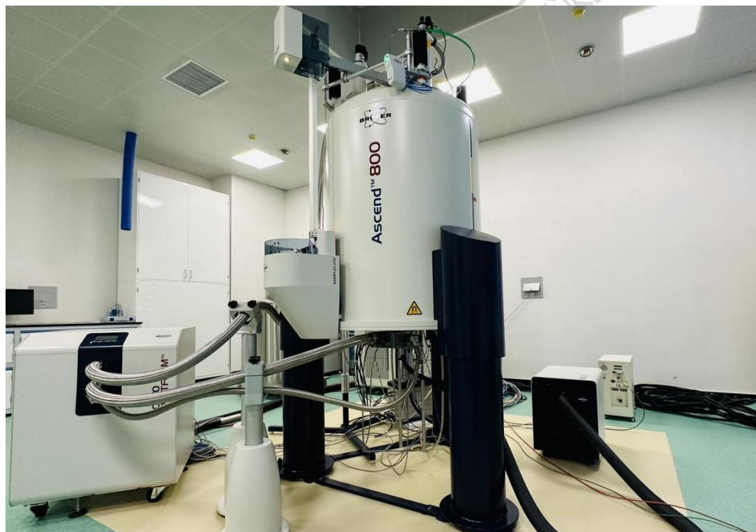
●图 1、化学所怀柔研究中心的布鲁克 AVANCE NEO 800 液体核磁谱仪
